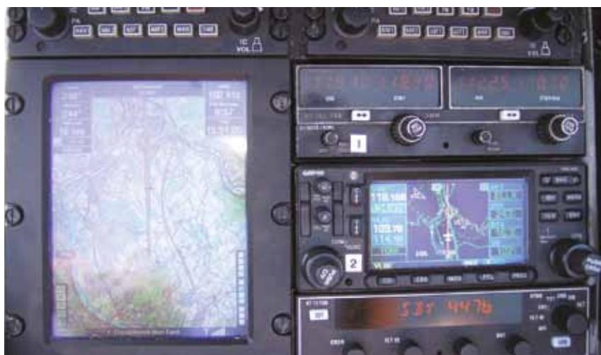
Das HeliMap-System im Cockpit reduziert die Arbeitsbelastung im Cockpit.
