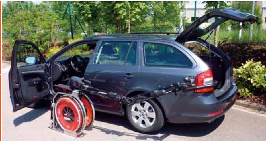
Robot de chargement d'un fauteuil roulant • Rollstuhlroboter als Ein- und Ausstiegshilfe
