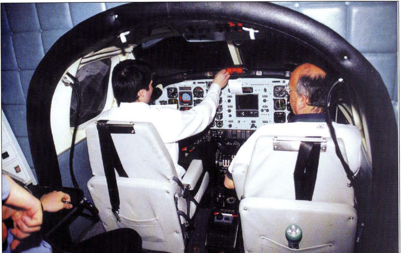
Im Cockpit des Simulators: Links im Bild erkennt man die Hand des Prüfers und einen kleinen Teil des Computers, der alle Flugbewegungen speichert
