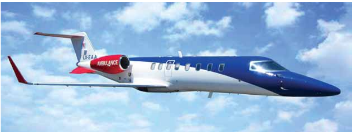
L'air poussé vers le bas de l'avion produit une force contraire sur l'aile, et l'appareil se trouve, par réaction, tiré vers le haut.
