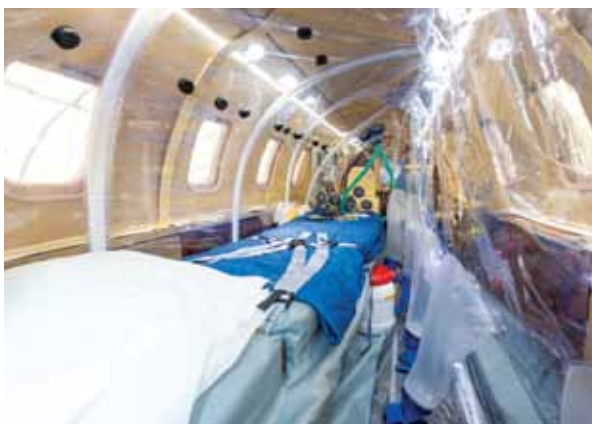
L'intérieur d'un avion sanitaire LAR en configuration «Ebola» avec une tente permettant d'isoler totalement un patient tout en lui délivrant des soins pendant le vol.
