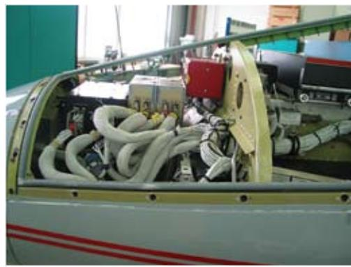
2. Ausbau und Überprüfung der Fluginstrumente aus dem Cockpit.
