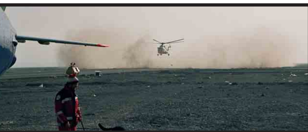
Durch den vielen aufgewirbelten Staub ist die Sicht bei Start und Landung beeinträchtigt (o)
