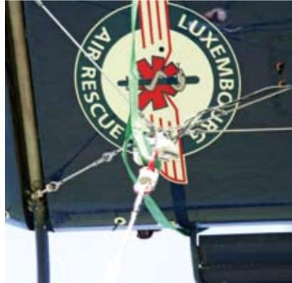
Die Befestigung des Rettungskorbes verfügt über ein Sicherheitssystem zur schnellen Lösung des Korbes. Insgesamt verfügt der Rettungskorb über eine Traglast von zirka 1.000 kg und ist somit zur Rettung von mehreren Personen gleichzeitig geeignet.
