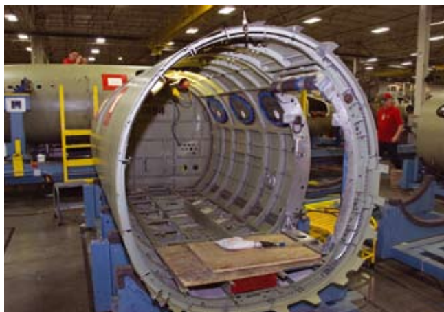
Une section de cellule de notre Mustang après la vérification qualité
