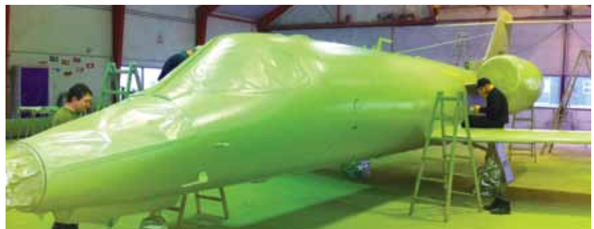
L'application de diverses couches d'alodine a créé une apparence de l'avion en couleur verte.
