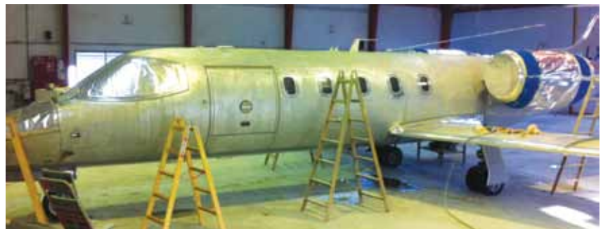
Un décapage chimique enlève la peinture précédente de l'aéronef.
