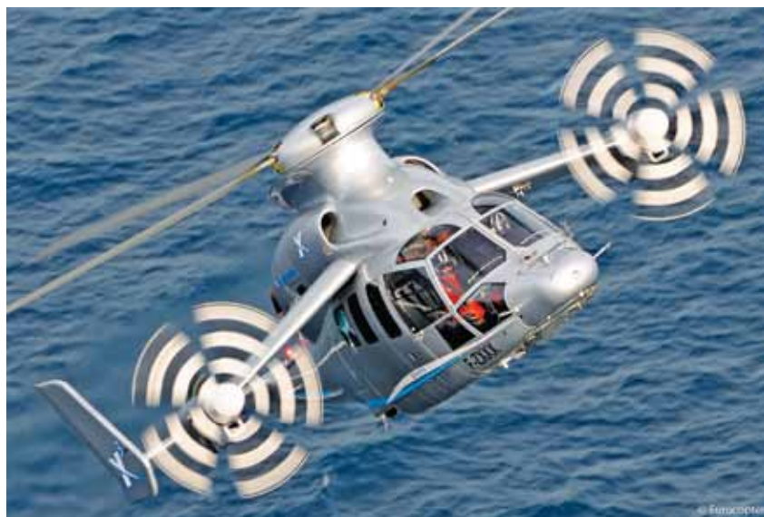
L'hélicoptère hybride X3 d'Eurocopter détient le record mondial avec une vitesse max. de 232 nœuds.
