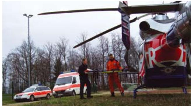
Christoph 22 muss so z.B. beachtet werden, dass das dort verwendete Hubschraubermodell über einen Heckrotor verfügt. Dies bedeutet somit eine zusätzliche Gefahrenquelle beim Starten, Landen und beim Annähern an den Helikopter, und das heißt für den HCM, der dem Piloten hierbei unterstützend zur Seite steht, dass er diesen Faktor zusätzlich beachten muss.
