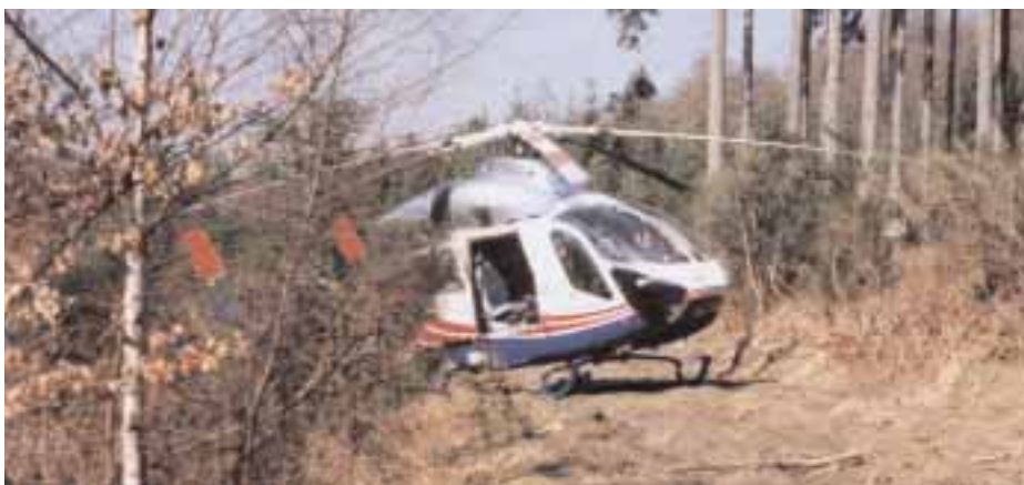
Der Hubschrauber der LAR landet auf einer Lichtung mitten im Wald. Dabei kommt ihm sein NOTAR-System zugute: Da der Hubschrauber kein Heckrotor hat, läuft er keine Gefahr, dass dieser sich im Unterholz verfängt und somit den Hubschrauber beschädigt. (o) Der Verunglückte wird versorgt. (u)
