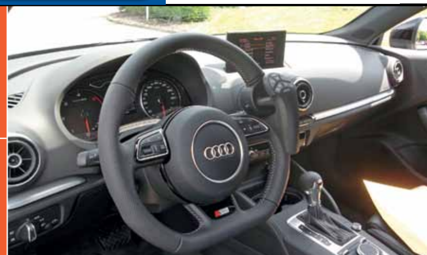
Lenkhilfe mit 7 Zusatzfunktionen • Boule au volant avec 7 fonctions supplémentaires
