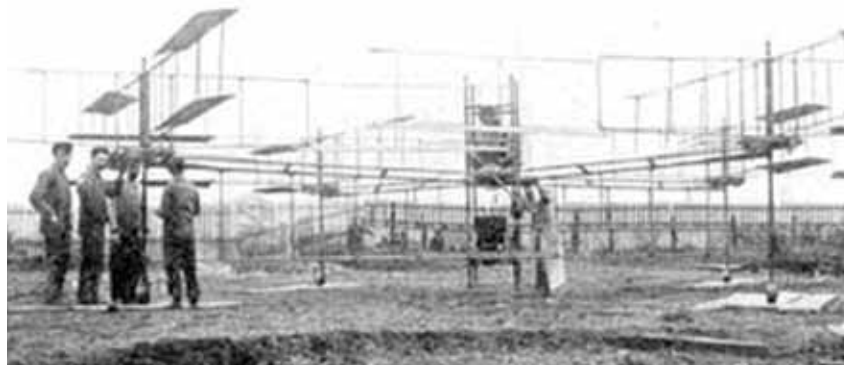
La machine de quatre rotors de plus de 8 mètres de Louis Breguet restait en lévitation pendant une minute à 60 centimètres du sol.
